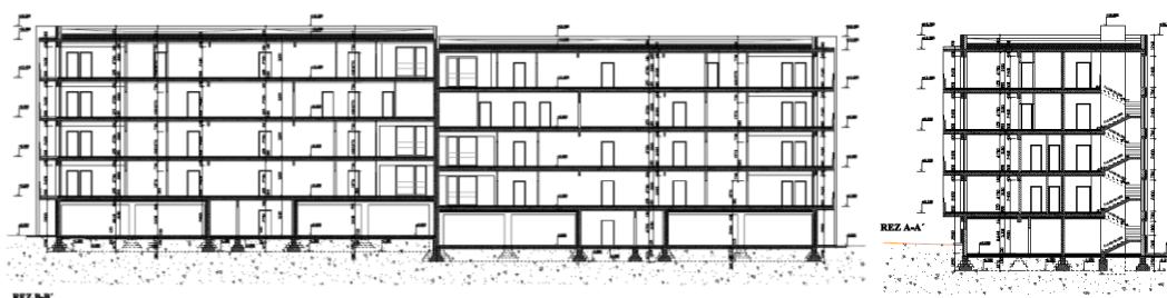
Obr. 3 Bytový dom - pozdĺžny a priečny rez objektom SO 01
